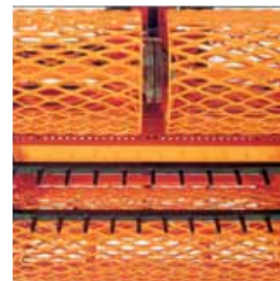
Le rouleau frontal émiette, la herse frontale affine, la herse arrière recouvre juste après le semis et le rouleau arrière plombe.
